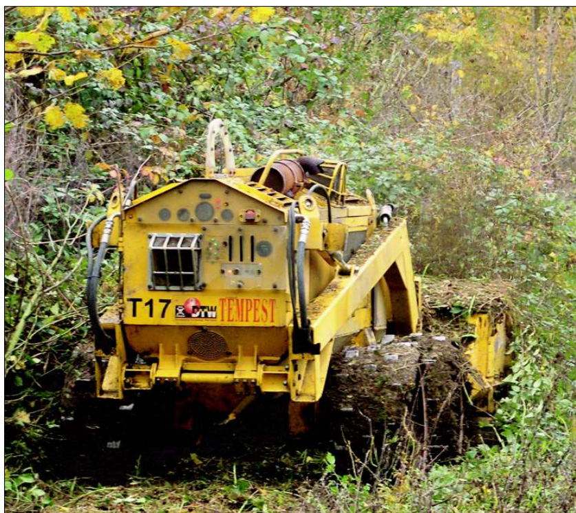
Mašina za skidanje vegetacije prije deminiranja TEMPEST MK5 FUCZ i RUCZ RS
